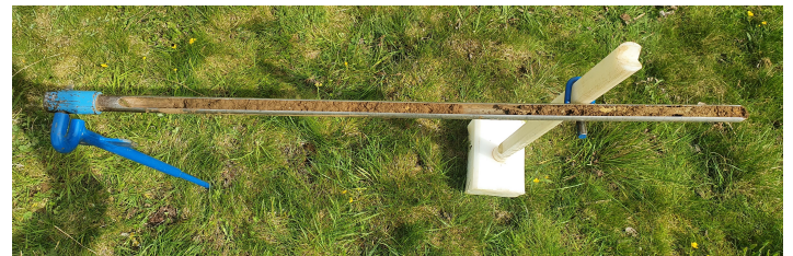
Abbildung des zum Einsatz kommenden "Pürckhauer"-Bohrstock
